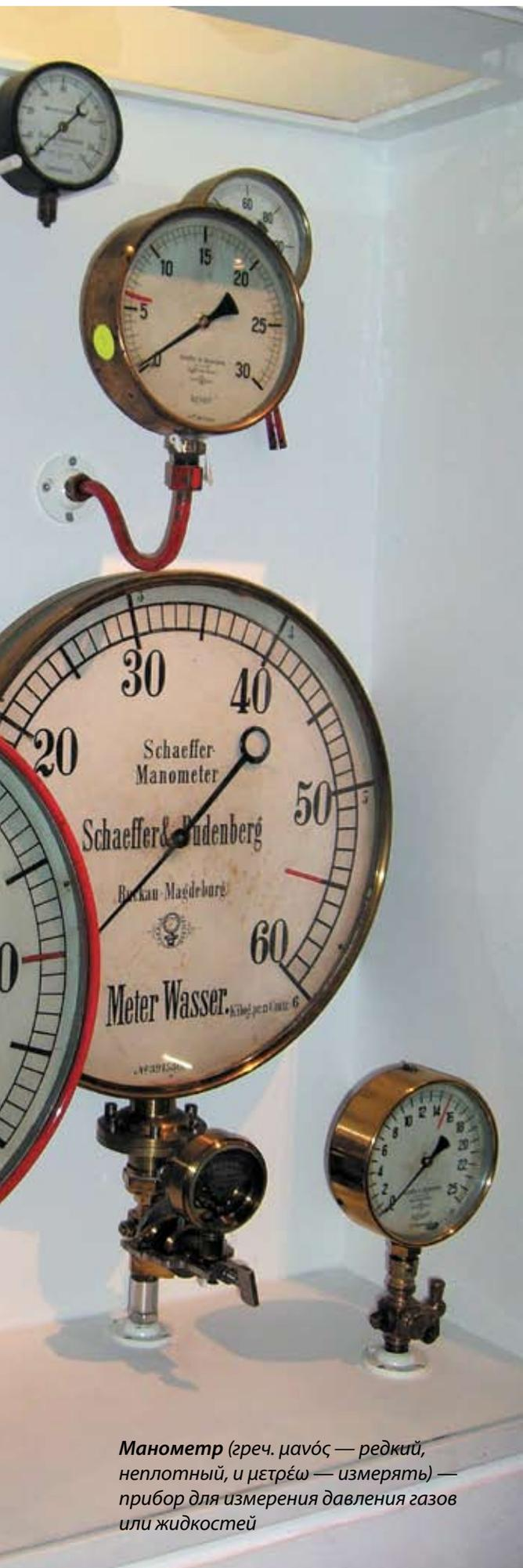
**Манометр** (греч. *μανός* — редкий, *μητρών* — измерять) — прибор для измерения давления газов или жидкостей
